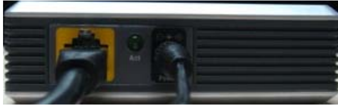
Şekil 5-SPA 3000 Güç Kablosu Bağlantısı
